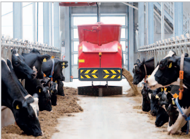
Nejčastěji se krmicí robot, který tvoří malý míchací vůz s dvěma vertikálními šneky, pohybuje ve stájích po nosné ocelové dráze umístěné pod střechem
