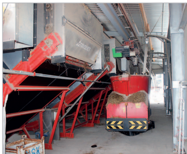
Robot si v kuchyni veškeré komponenty sám naloží, zamíchá a dopraví je na krmný stůl nebo do žlabu
